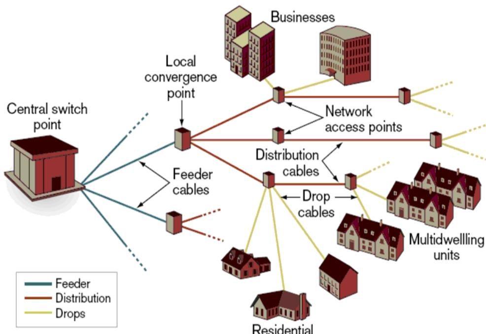
Εικόνα 5: Βασική δομή δικτύου FTTx (Πηγή: Keiser, 2006)
